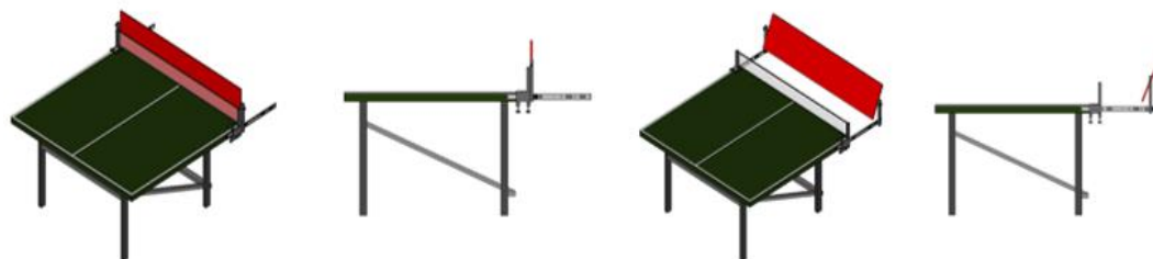
Gambar 4. Rangka rel geser dipersingkat dari 55 cm menjadi 45 cm.
