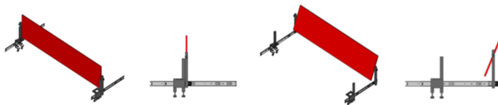
Gambar 5. Desain dengan rel geser 45 cm yang dioptimalkan dan ketebalan papan 12 mm.
