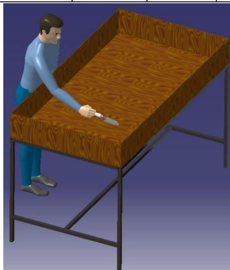
Gambar 9. Usulan Perbaikan Bak Biopond dan Posisi Tubuh Pekerja
